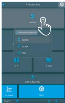
内置的程序可提供完整精确的核酸测量，可使用Thermo Scientific™  $\mu$ Drop™ Plate，微孔板或比色杯测量 dsDNA、ssDNA、RNA或用户自定义核酸
