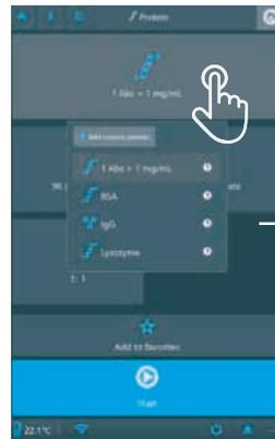
内置蛋白测量程序，可使用 Thermo Scientific™  $\mu$ Drop™ Plate，微孔板或比色杯测量4种内置类型的蛋白或自定义种类的蛋白
